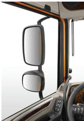
Большие зеркала с защитой от вибрации обеспечивают прекрасный обзор зоны сзади, по бокам или перед автомобилем, охватывая области, которые не видны напрямую через стекло.
